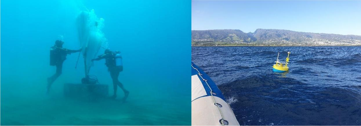
Figure 12 – Photos illustrant le corps mort utilisé pour stabiliser la position de la bouée (photo de gauche) et la bouée connectée (photo de droite)
