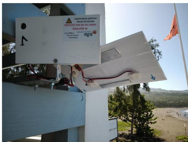
Figure 5 - SolarCam et son panneau solaire installés au niveau du poste de secours d'Etang Salé
