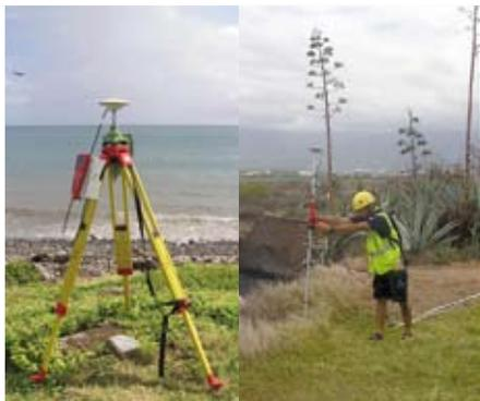
Station fixe (à gauche) et mobile (à droite) du système DGPS pour la topographie
