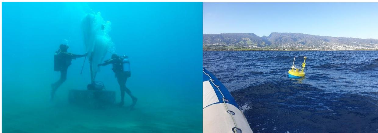
Figure 8 – Photos illustrant le corps mort utilisé pour stabiliser la position de la bouée (photo de gauche) et la bouée connectée (photo de droite)
