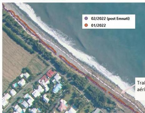
Le front de mer de Champ Borne est composé d'un cordon sédimentaire d'origine alluvionnaire et surmonté d'un talus artificiel (remblai). Ce dernier présente d'importantes falaises d'érosion suite à des événements extrêmes tels que des cyclones.
