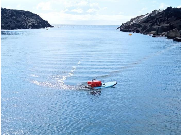
Figure 15 – Drone flottant télé-opéré pour les acquisitions bathymétriques sur la plage de l'Etang-Salé
