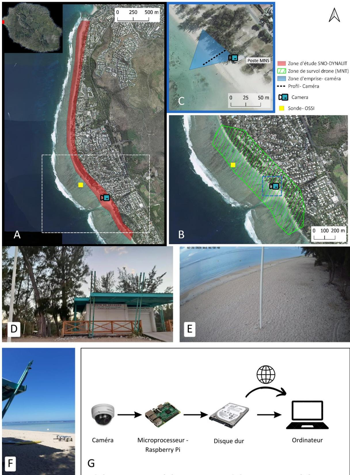
Figure 8 : Localisation et caractéristiques du système d'observation par caméra des processus hydrodynamiques que le site MNS
