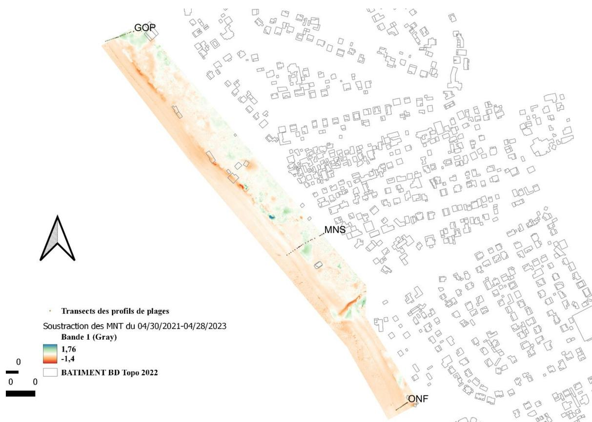
Figure 21 : Soustraction des MNT du 04/30/2021 au 04/28/2023 sur la passe de l'Hermitage entre les profils GOP et ONF
